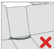
**⚠ DIESER SITZ IST NUR FÜR DEN EINBAU IN FAHRZEUGEN GEEIGNET, DIE MIT EINEM 3-PUNKT-SICHERHEITSGURT AUSGESTATTET SIND – diagonal (sh) und Beckengurt (L), GEMÄSS UNECE-REGELUNG Nr. 16 oder GB 14166 GENEHMIGT.**
