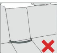
**⚠ CE SIÈGE CONVIENT UNIQUEMENT À L'INSTALLATION DANS DES VÉHICULES ÉQUIPÉS D'UNE CEINTURE DE SÉCURITÉ À 3 POINTS - diagonale (sh) et abdominale (L) APPROUVÉE SELON LE RÈGLEMENT UNECE N° 16 ou GB 14166.**
