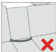
**⚠ ACEST SCAUN ESTE ADEVĂRT NUMAI PENTRU MONTAREA ÎN VEHICULE ECHIPATE CU CENTURĂ DE SIGURANȚĂ ÎN 3 PUNCTE - diagonală (sh) și poală (L) OMOLOGAT CONFORM REGULAMENTULUI UNECE Nr. 16 sau GB 14166.**
