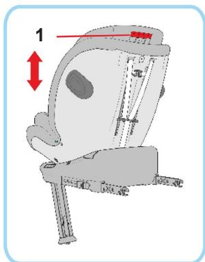
**ATENCIÓN** Antes de instalar el asiento, ajuste el reposacabezas a la altura del niño. El reposacabezas puede ajustarse en 11 posiciones.
