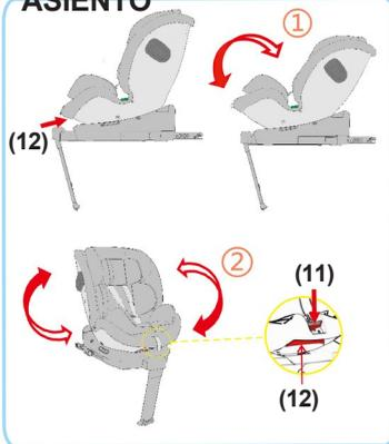
1 - Presione la palanca de reclinación (12) y coloque el asiento en la posición adecuada.
