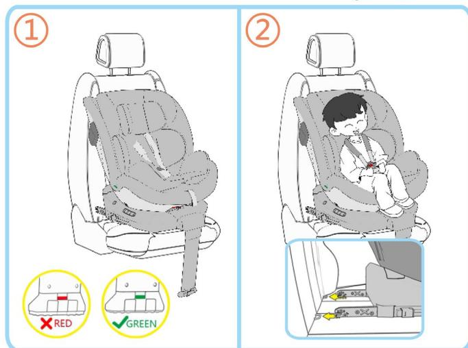
**Paso 1:** Instale la silla de auto en el vehículo con fijaciones ISOFIX (consulte "AJUSTE DE LAS FIJACIONES ISOFIX" e "INSTALACIÓN DE LAS FIJACIONES ISOFIX"). Empuje firmemente el respaldo de la silla de auto hacia el respaldo del asiento del vehículo y asegúrese de que la silla de auto quede bien presionada.
