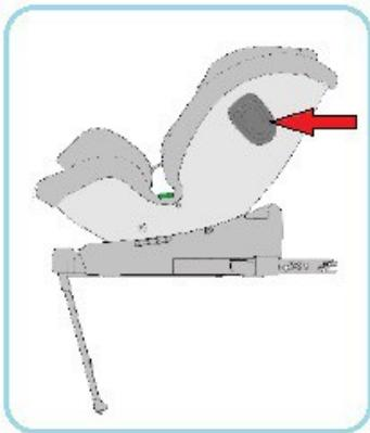
El sistema de protección lateral adicional SPS está diseñado para que, en caso de impacto lateral, reduzca la energía y absorba la tensión en la cabeza y el cuello del bebé.
