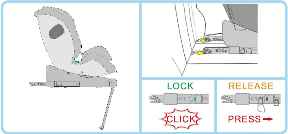
**Paso 1:** Tire al máximo de los enganches ISOFIX e introdúzcalos en los anclajes ISOFIX del vehículo. Presione la silla de auto hacia atrás hasta que oiga un clic y se fije.
