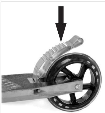
Quando desee reducir la velocidad o detenerse, deslice el pie hacia atrás y pise lentamente el freno. Esto ralentizará o detendrá el scoter.
