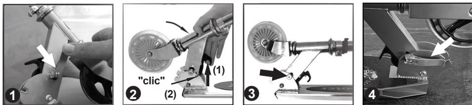
1. Tire de la palanca y desensrosque el perno.
