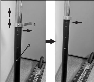
Suelte el soporte de fijación de altura tirando de él hacia fuera (1). Presione el pasador (2) y mueva el manillar hacia arriba o hacia abajo a la altura deseada hasta que oiga un clic y el pasador asome por su orificio. Apriete el soporte (3). Asegúrese de que el manillar está bien fijado.
