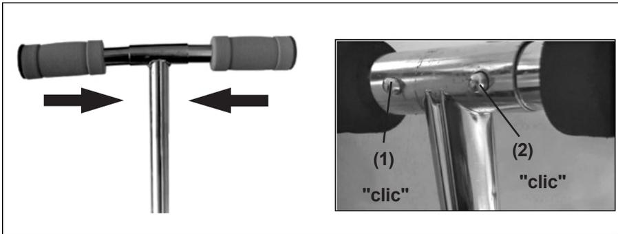
Coloque las empuñaduras a ambos lados del manillar. Empuje ambas empuñaduras hasta que los pasadores asomen por los orificios y oiga un clic.
