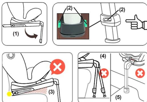
1. Presione ligeramente la pata de apoyo y gírela hacia delante, como se muestra en la figura.
