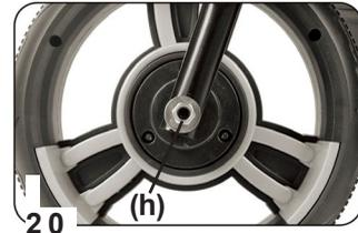
17. Coloque la rueda delantera entre los tubos de la horquilla, de modo que la ranura de la rueda coincida con las ranuras de la horquilla.
