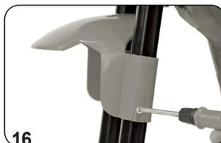
15. Enrosque el guardabarros a través de los tubos de la barra de dirección.
