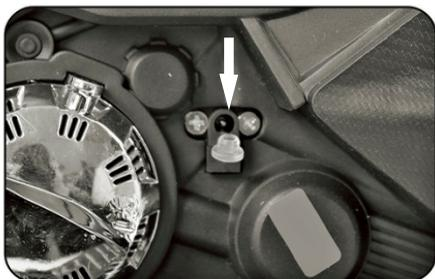
El enchufe de carga del juguete se encuentra a un lado del cuerpo del juguete, debajo del asiento. Abra la tapa de la toma del cargador. Enchufe el cargador en la entrada de la motocicleta. Enchufa el cargador a la toma de corriente. La batería comenzará a cargarse.
