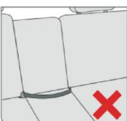
**⚠️ Tuto sedačku lze namontovat pouze do vozidel vybavených tříbodovým bezpečnostním pásem - diagonálním (sh) a břišním (L) SCHVÁLENÝM PODLE PŘEDPISU EHK OSN č. 16 nebo GB 14166.**
