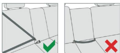
**⚠ ACEST SCAUN ESTE ADEVĂRT NUMAI PENTRU MONTAREA ÎN VEHICULE ECHIPATE CU CENTURĂ DE SIGURANȚĂ ÎN 3 PUNCTE - diagonală (sh) și poală (L) OMOLOGAT CONFORM REGULAMENTULUI UNECE Nr. 16 sau GB 14166.**
