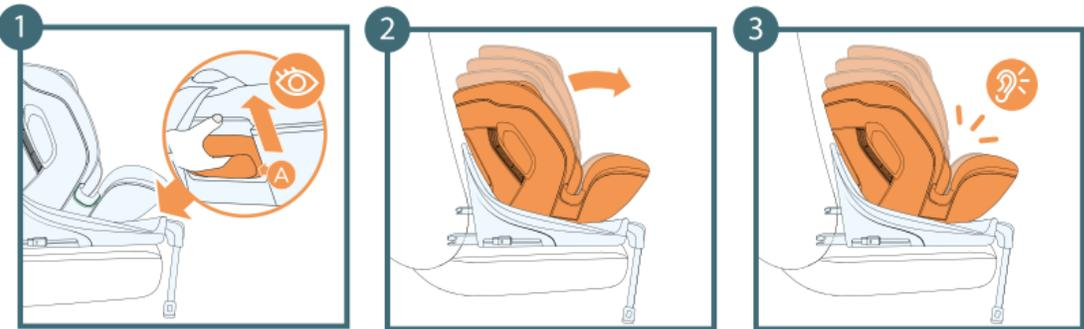
**A: Alavanca de ajuste de inclinação do assento**
