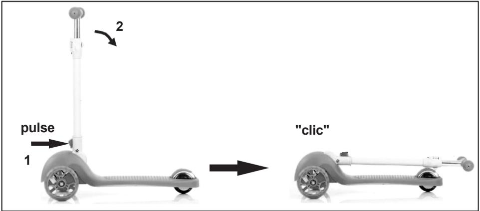
Pulse el botón de despliegue (1) y, a continuación, presione el manillar hacia abajo (2), hasta que el scooter quede plegado y oiga un clic.
