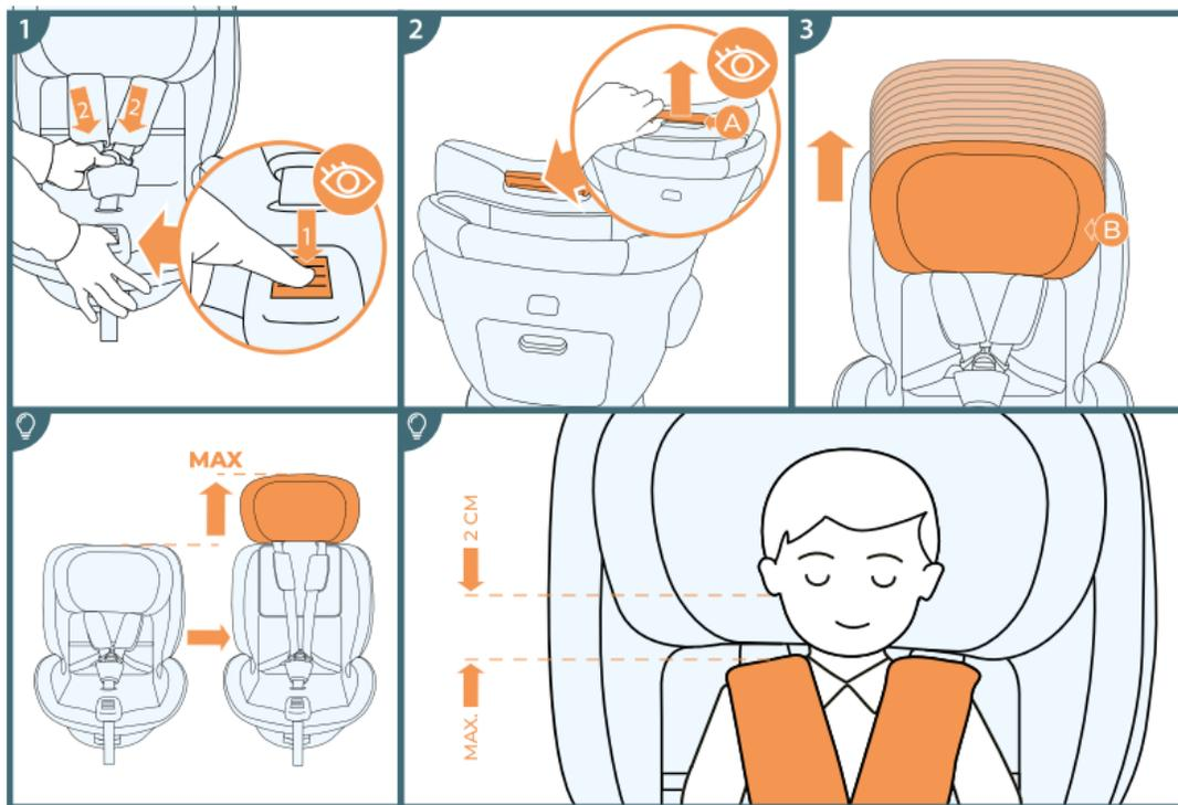
**A:** Palanca de regulación de la altura del reposacabezas
