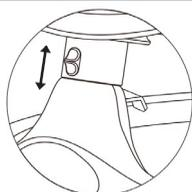
Mueva el control deslizante hacia abajo para mantener el marco inmóvil y detener la función de balanceo.
